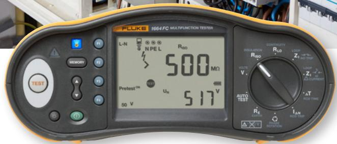
的火线、中线和地线。请注意, 在断开负载的情况下用有电压的电路进行测试。1660 系列测试仪也可执行预测试, 以确定实际测试是否会产生 50 V 或 25 V 以上的故障电压。对于 S 型 (时间延迟) RCD, 设置 1660 装置为 S 型模式。这意味着, 预测试和实际测试激活之间有 30 秒的时间延迟, 以避免出现不准确的脱扣时间。
