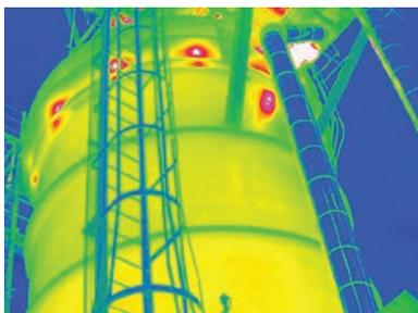
评估储罐的腐蚀情况或结构完整性。
