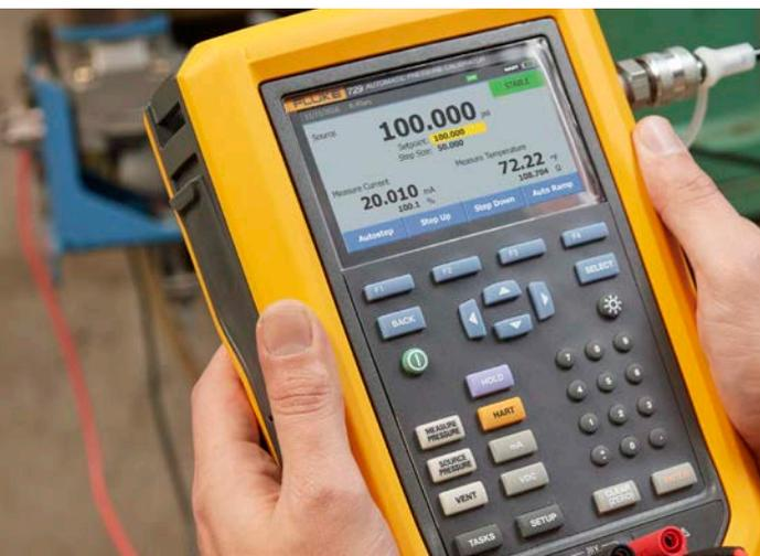
“借助 729，设置一次即可自动测试多个压力点。我们可以直达低气压设定点，无需释放压力并重新提升压力，这确实让我们的工作更有效率。”
