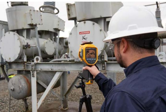
图 1. 一名检验员使用 Fluke Ti450 SF6 气体检测仪检测螺栓连接。
